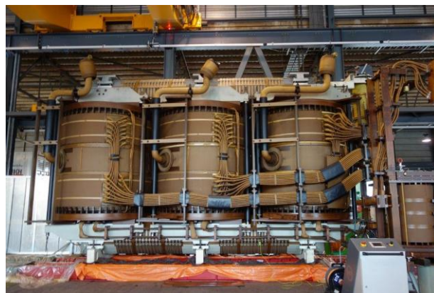
Innvendig konstruksjon av en krafttransformator.
