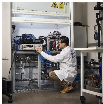
PEM-brenselcellesystemlaboratorium på IFE med mulighet for testing og avansert karakterisering av PEM cellepakker. Foto: B. A. Ward
